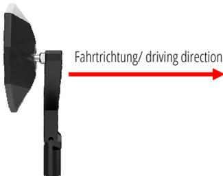
Der Spiegelarm muss in einem Winkel von 45° positioniert und fixiert werden!
