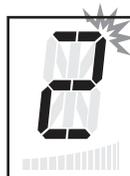
In den 2. Gang schalten und 2.500 ~ 3.500 U/min beibehalten, bis „-“ blinkt, bevor automatisch die nächste Ziffer „3“ angezeigt wird. Auf diese Weise bis zur Einstellung der letzten Ziffer (des höchsten Ganges) fortfahren.
