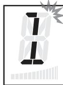
Sobald der 1. Gang erkannt wird, blinkt „-“ kurz auf, bevor automatisch die nächste Ziffer „2“ angezeigt wird.
